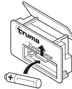
¡Utilice solamente baterías tipo Mignon resistentes al calor (+70° C) antiderrames (LR 6, AA, AM 3, N° de art. 30030-99200), otras baterías pueden ocasionar perturbaciones de funcionamiento!
