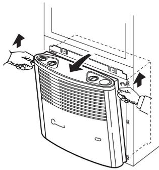
Anschließend die Verkleidung seitlich anstellen, damit eventuelle Anschlusskabel (z. B. für den Piezozünder, für das Warmluftgebläse sowie für die Zündkontrolllampe oder das Kaminfeuer) nicht abgesteckt werden müssen.
