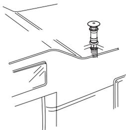
Nell'ambito delle diverse condizioni di consegna dei veicoli, il costruttore del camper o l'installatore della stufa è tenuto a stabilire, eventualmente insieme a Truma e mediante giri di prova, la combinazione ottimale tra tiraggio e prolunghie. A seconda del tipo di veicolo e delle strutture dei tetti, può essere necessario il tiraggio T1 (n° art. 30700-01) oppure T2 (n° art. 30700-02).
