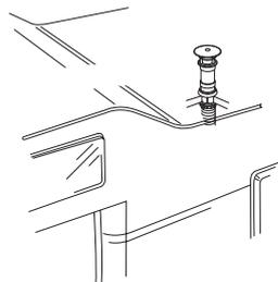
Le constructeur de camping-car ou le monteur de chauffage doit déterminer la combinaison de chapeau de cheminée et éventuellement de rallonges dans les différents états de livraison des véhicules en procédant à des trajets d'essai et le cas échéant en s'entendant avec Truma. En fonction du type de véhicule et des superstructures de toit, le chapeau de cheminée T1 (n° d'art. 30700-01) ou T2 (n° d'art. 30700-02) peut être nécessaire.
