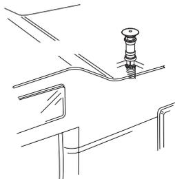
El fabricante del coche vivienda o el montador de la calefacción debe determinar mediante marchas de prueba la combinación de suplemento de chimenea y dado el caso prolongaciones para los estados de suministro individuales de los vehículos, y eventualmente, coordinar con Truma. Dependiendo del tipo del vehículo y de las superestructuras del techo, puede ser necesario el suplemento de chimenea T1 (Nº de art. 30700-01) o T2 (Nº de art. 30700-02).
