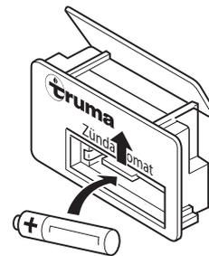
N'utiliser que des piles Mignon étanches résistant à la chaleur (+70° C – LR 6, AA, AM 3, n° d'art. 30030-99200); d'autres piles peuvent causer des défauts de fonctionnement !
