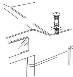
Autocamperproducenten eller varmeovnsmontøren skal undersøge kombinationen af skorsten og evt. forlænger for de enkelte køretøjer ved prøvekørsel samt evt. kontakte Truma. Alt efter køretøj og tagkonstruktion kan det være nødvendigt at montere skorsten T1 (art.-nr. 30700-01) eller T2 (art.-nr. 30700-02).
