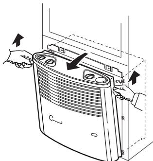
Ensuite, mettre la façade sur le côté afin qu'il ne soit pas nécessaire de débrancher d'éventuels câbles de connexion (par exemple pour l'allumeur piézo-électrique, pour la soufflerie d'air chaud ainsi que pour le témoin lumineux de contrôle d'allumage ou le feu de cheminée).
