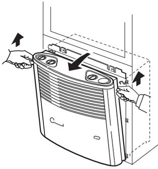
Daarna de ommanteling tegen de zijkant wegzetten, zodat eventuele aansluitkabels (b.v. voor de piëzo-ontsteker, voor de warme-luchtventilator alsmede voor de ontstekingscontrolelamp of het haardvuur) niet losgetrokken hoeven te worden.
