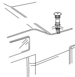
Der Reisemobilhersteller bzw. Heizungseinbauer muss die Kombination von Kaminaufsatz und ggf. Verlängerungen bei den einzelnen Auslieferungszuständen der Fahrzeuge durch Versuchsfahrten ermitteln und gegebenenfalls mit Truma abstimmen. Abhängig vom Fahrzeugtyp und von den Dachaufbauten kann der Kaminaufsatz T1 (Art.-Nr. 30700-01) oder T2 (Art.-Nr. 30700-02) erforderlich sein.
