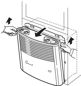
A continuación, colocar al lado la fachada, para que no tengan que desacoplarse los cables de conexión que pudiera haber (p. ej. para el encendido piezoeléctrico, para el ventilador de aire caliente, así como para el testigo de control de encendido o el efecto fuego).
