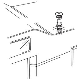
De camperfabrikant resp. inbouwfirmas van de verwarming moet de combinatie van schoorsteenopzetstuk en evt. verlengingen bij de afzonderlijke leveringstoestanden van de voertuigen vaststellen middels proefritten en evt. met Truma afstemmen. Afhankelijk van het voertuigtype en van de dakopbouw kan het schoorsteenopzetstuk T1 (art.-nr. 30700-01) of T2 (art.-nr. 30700-02) noodzakelijk zijn.
