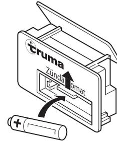
Usare solo pile mignon resistenti al calore (+ 70° C) ed ermetiche (LR 6, AA, AM 3, n° art. 30030-99200), altri tipi di pile possono provocare anomalie di funzionamento!
