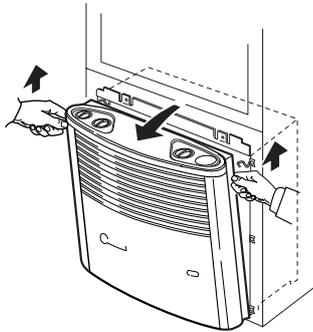
Appoggiare poi lateralmente il rivestimento, in modo che gli eventuali cavi di collegamento (p.es. per l'accenditore piezoelettrico, il ventilatore ad aria calda, nonché la spia luminosa di accensione o il fuoco camino non debbano essere disinseriti).
