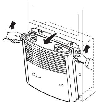
Placer beklædningen på siden, så eventuelle tilslutningskabler (f.eks. til piezotænderen, til varmluftblæseren samt til tændingskontrollampen eller kaminilden) ikke skal afmonteres.
