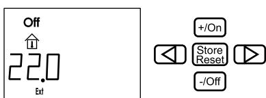
Wanneer externe start wordt geactiveerd, zal de verwarming met de laatst uitgevoerde instellingen starten en "ON" (hoofdschakelaar) verschijnt op de display. Indien er geen 12V op de verwarming is aangesloten, zal de display
