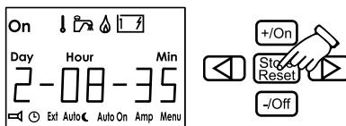
Indien de stroomtoevoer naar het bedieningspaneel wordt verbroken en er geen batterijbackup is aangesloten moet de tijd opnieuw worden ingesteld.
