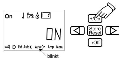
Wenn Sie zum Fahrzeug kommen und AutoOn ist aktiviert, deaktivieren Sie AutoOn, damit sich die Heizung nicht nach 24 Stunden abschaltet. (Die Heizung kann nicht abgeschaltet werden, wenn AutoOn
