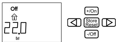
Wenn Extern Start aktiviert ist, wird die Heizung mit den letzten Einstellungen anlaufen und „ON“ (Hauptschalter) leuchtet auf. Falls keine 12V-Versorgung für die Heizung zur Verfügung steht, bleibt das Display aus, bis wieder 12V anliegen. Die Funktion Extern Start ist weiterhin aktiviert. Um die
