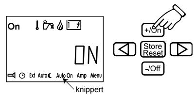
Wanneer u weer bij het voertuig komt en de functie AutoOn is geactiveerd, dient de functie AutoOn te worden uitgeschakeld om te voorkomen dat de verwarming na 24 uur wordt uitgeschakeld (de ketel kan
